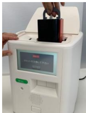
薬をカセットに入れて装填
