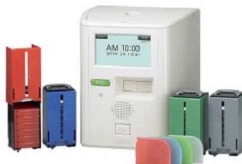
「服薬支援ロボ」と4種類に色分けしたカセットとピルケース
