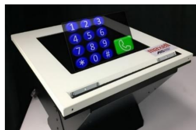
マクセルが開発した高輝度空中ディスプレイ (表示イメージ)
